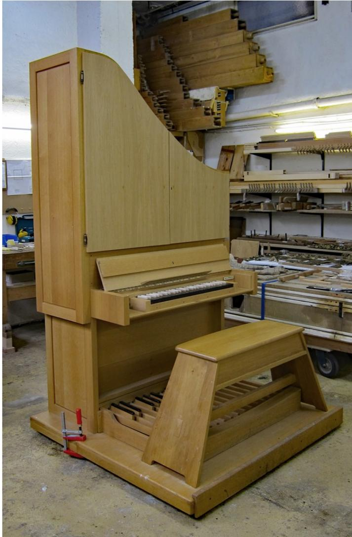
Schleiflade mit mechanischer Ton- und Registertraktur. Integrierte Windversorgung mit Gebläse. Stimmung 440 Hz bei 15°C gleichschwebend. Stabiles Gehäuse in Eiche massiv mit verschließbaren Flügeltüren. Robuste, zuverlässige Mechanik. Passende Sitzbank. Zweiteiliges, fahrbares Podest.
